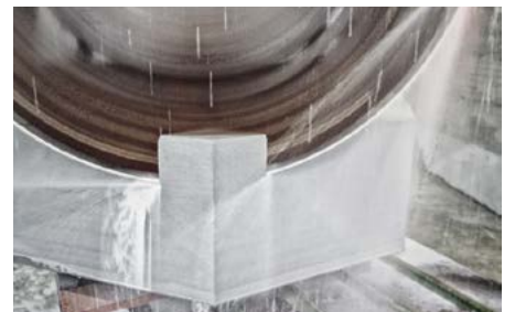
7 Die Ecken werden erneut abgefräst, um so der runden Grundform stets näherzukommen.
