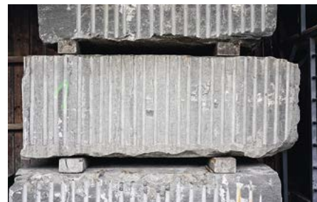
1 Die Arbeit beginnt mit der Auswahl des passenden Sandstein-Rohblockes, Abmessung ca. 2 x 2 Meter, Höhe 1 Meter.
