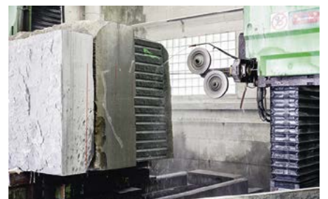
2 Das Zuschneiden der Rohplatte auf die gewünschte Blockgrösse erfolgt mittels Diamantseil-Sägetechnik.
