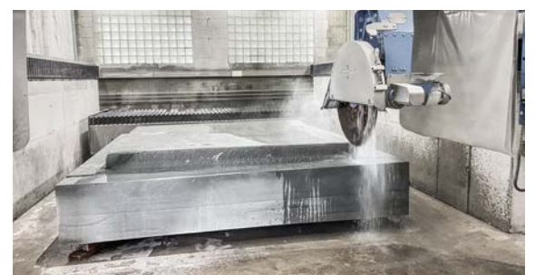
Mit höchster Präzision schneidet und fräst unsere 5-Achs-Maschine aus dem rohen Klotz eine präzise Brunnenform.
