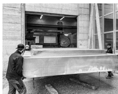
Mit Fingerspitzengefühl und unter Aufsicht eines Schwertransportteams wird der Brunnen millimetergenau unter der 5-Achs-Fräse positioniert.
