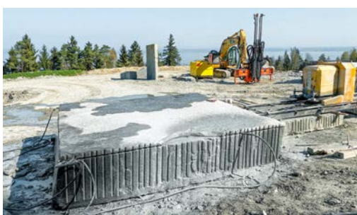
Der Abbau grosser Rohblöcke erfordert viel Geschick und Feingefühl. In unserem Steinbruch sind Blockgrössen von 4,5 \times 8 m möglich. Hier der 4,5 \times 4,5 \times 1 m grosse Rohblock für den Brunnen.
