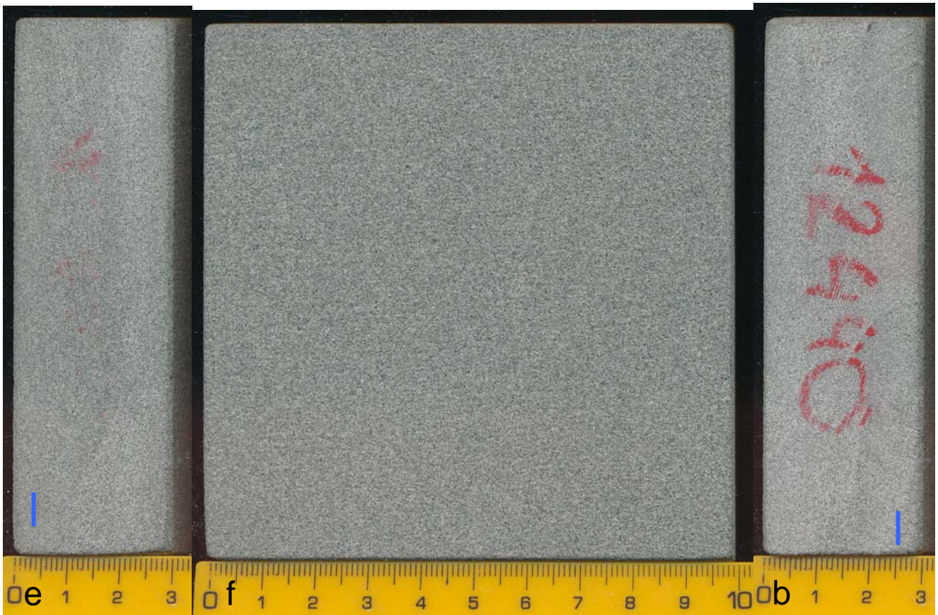
Abbildung 1f: Untersuchtes Gesteinsmuster LGA224-20V30043. Feinsandstein. Gesamtfarbe quadratische Fläche: insgesamt gleichmäßig hell grünlich grau mit homogener Farbverteilung, Hellglimmer (Muskovit) in Abbildung nicht erkennbar; Seitenfläche: undeutlich erkennbare Parallelschichtung (Feinschichtung) mit geringen Farbunterschieden. Die Richtung der sedimentären Schichtung ist durch blaue Linien markiert. Die roten Linien und das rote Rechteck markieren die Position des Dünnschliffs. Probe LGA224-20V30043 trocken, sägerauhe Oberflächen.
