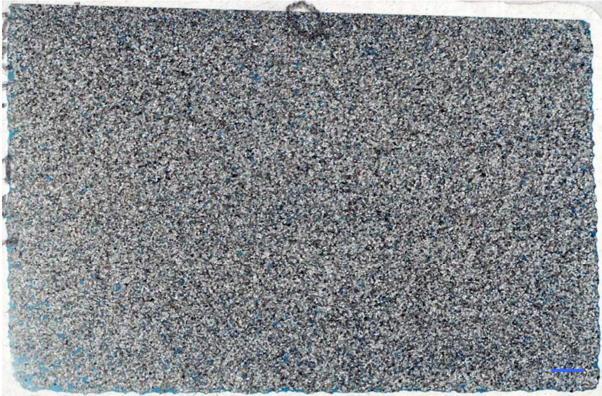
Abbildung 2c: Scan des petrographischen Dünnschliffs. (c) Durchlicht. Detritische Komponenten: Quarz, Alkalifeldspat, Plagioklas, Quarzit, Glimmerquarzit, Chloritquarzit: farblos, makroskopisch nicht unterscheidbar; , Phyllit, Goethit: gelbbraun; Porenzement: Carbonat: blaßbraun; offener Porenraum: blau. Die blaue Linien markiert die Lage der Schichtung, welche bei Schrägaufsicht als schmale dunklere und breitete hellere Streifen erkennbar wird. Darstellung des offenen Porenraumes mit blau eingefärbtem Kunstharz. Dünnschliffbreite entspricht 38,8 mm. Dünnschliff LGA223-1819053.
